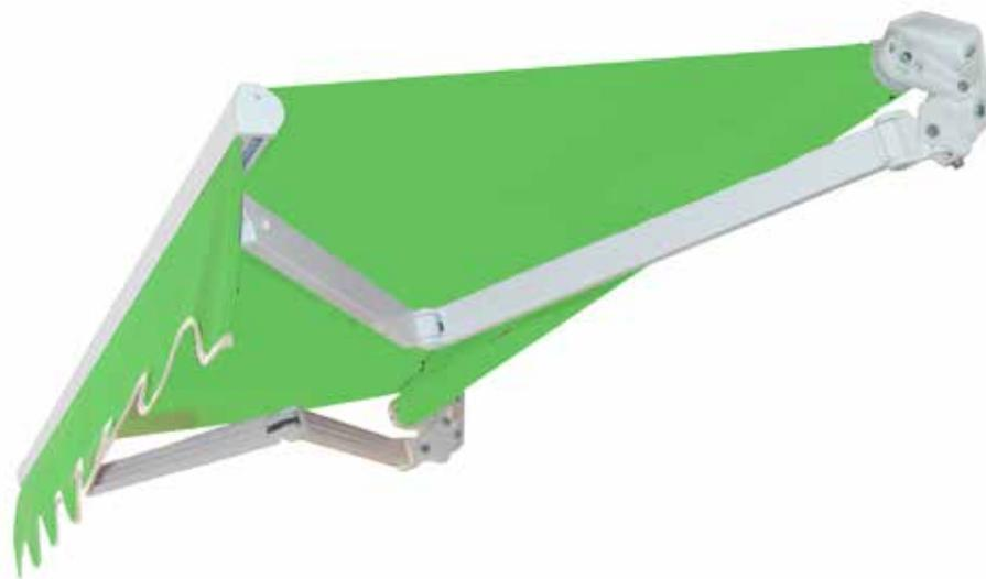
Tenda a bracci estensibili con catena inox realizzata su staffe laterali indipendenti fisse con regolazione leva incastro. Fornita con tubo avvolgitore diam. 70 mm, dispone come optional di un tettuccio di protezione in alluminio.
