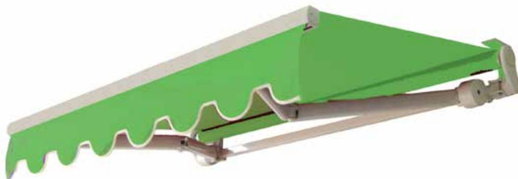
Tenda a bracci estensibili su barra quadra 40x40 in acciaio zincato e verniciato con bracci a catena inox e supporti dal design innovativo dotati di regolazione conica. La regolazione dell'inclinazione avviene in modo continuativo.
