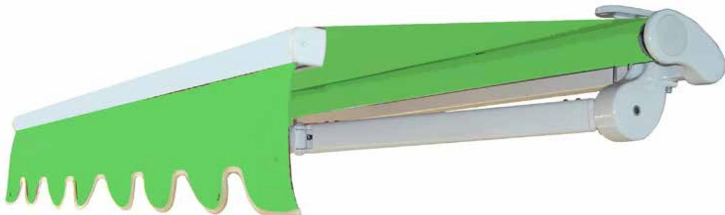
Tenda a bracci estensibili su barra quadra 40x40 in acciaio zincato e verniciato con bracci a catena inox e supporti dal design innovativo dotati di regolazione conica. La regolazione dell'inclinazione avviene in modo continuativo.
