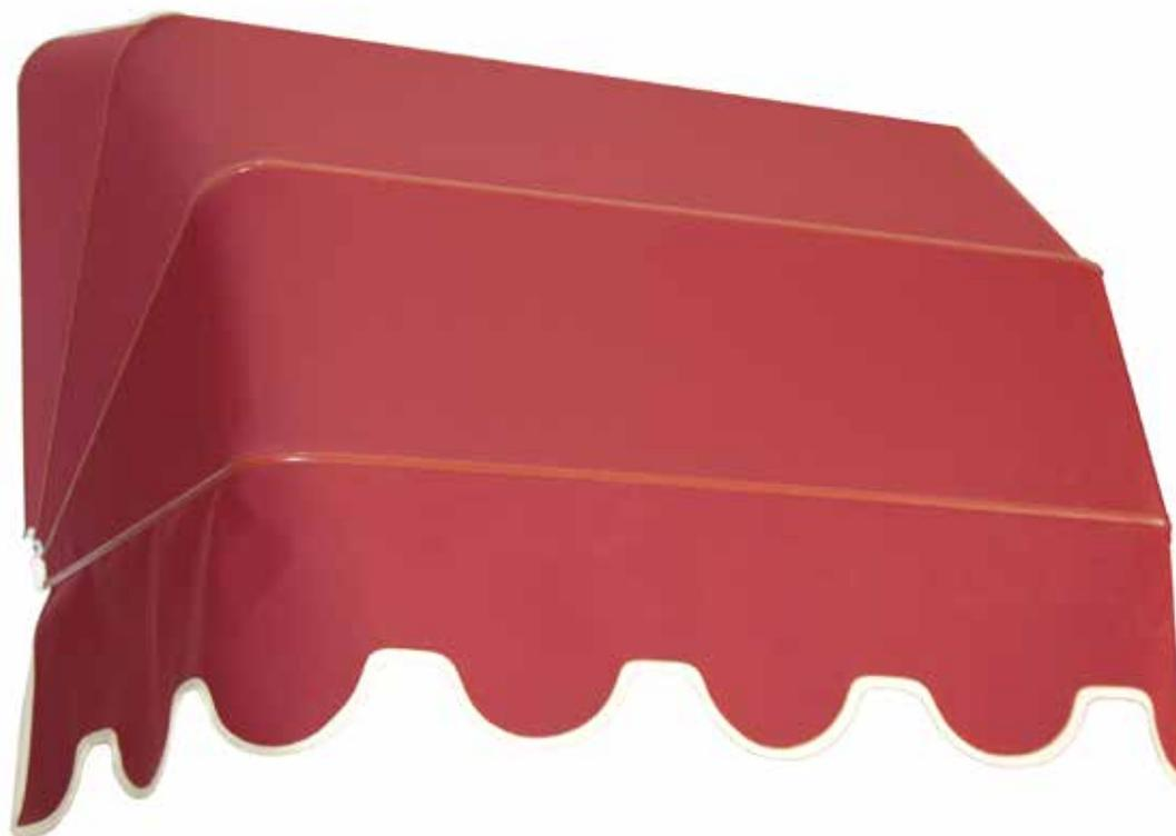
Tenda a cappottina con struttura in alluminio a settore circolare con raggiera ad angolo di 90°. Realizzata con profili mm 14,8 x 45 e accessori in nylon. Le dimensioni sono variabili in base alle esigenze.
