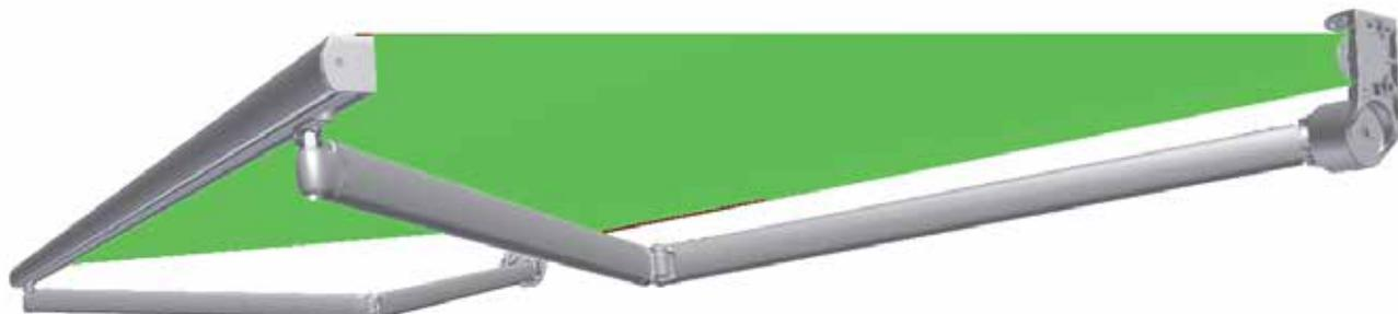
Tenda a bracci estensibili con catena inox realizzata su staffe laterali indipendenti fisse con regolazione conica. Fornita con tubo avvolgitore diam. 70 mm, offre 3 diverse tipologie di installazione: parete, soffitto e spallina. Dispone come optional di un tettuccio di protezione in alluminio.
