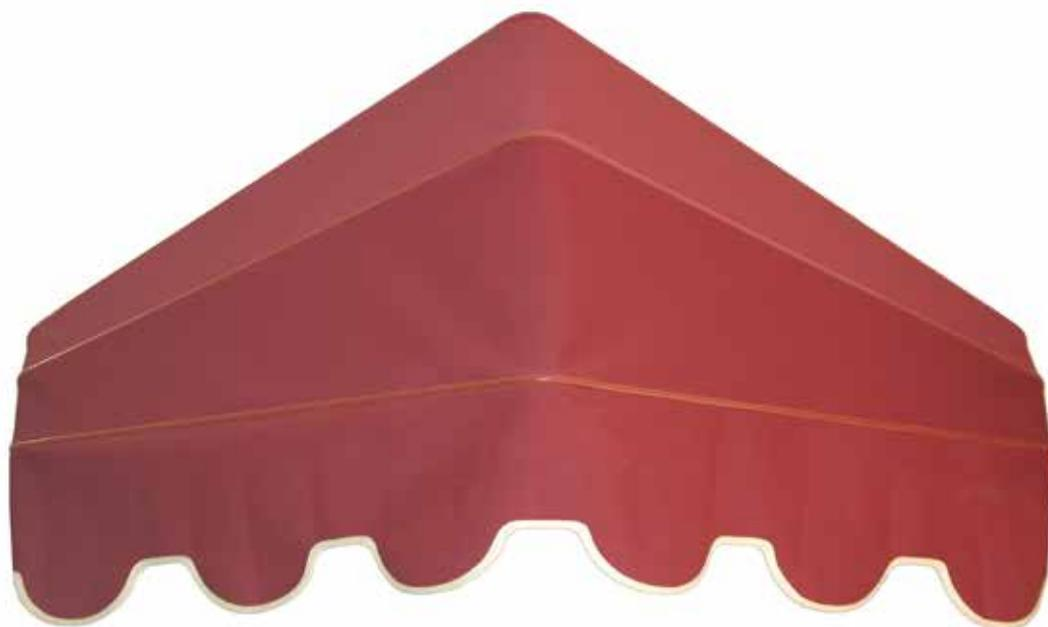
Tenda a cappottina con struttura in alluminio con raggiera ad angolo variabile. Realizzata con profili mm 14,4 x 50 e accessori in alluminio modulari ed intercambiabili con quelli delle altre cappottine. Le dimensioni sono variabili in base alle esigenze.
