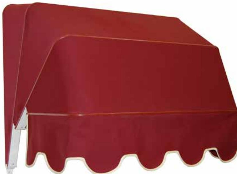
Tenda a cappottina con struttura in alluminio con raggiera ad angolo variabile, la cui particolare geometria consente di avere ingombri frontali ridotti rispetto alle coperture laterali. Realizzata con profili mm 14,4 x 49,8 e accessori in alluminio modulari ed intercambiabili con quelli delle altre cappottine. Le dimensioni sono variabili in base alle esigenze.
