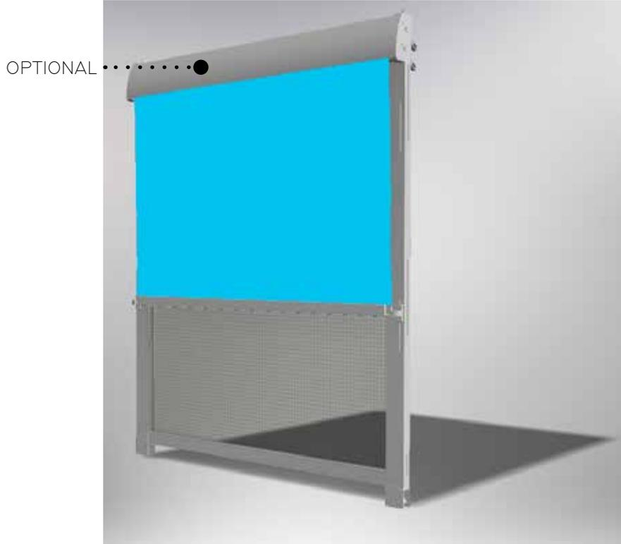
Tenda con a doppio rullo a caduta con scorrevoli sul lato estivo e aggancio automatico sul lato invernale con il telo che scorre all'interno delle guide per 6,5 cm, con sistema zippato. Si può realizzare sia con movimentazione manuale che motorizzata
