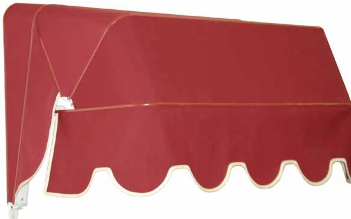
Tenda a cappottina con struttura in alluminio a settore circolare con raggiera ad angolo di 90°, la cui particolare geometria consente di distanziare la cappottina dalla parete mantenendo invariata la curvatura della stessa. Realizzata con profili mm 14,4 x 49,8 e accessori in alluminio modulari ed intercambiabili con quelli delle altre cappottine. Le dimensioni sono variabili in base alle esigenze.
